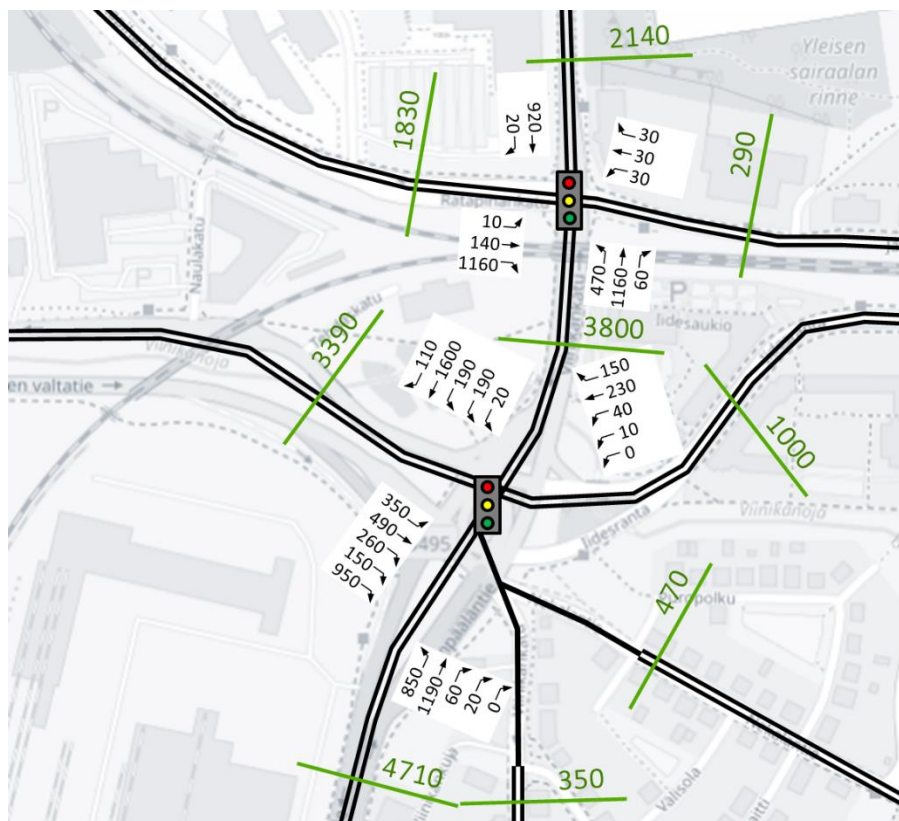
Kuva 6, Toimivuustarkasteluissa käytetyt vuoden 2040 iltahuipputunnin liikennemäärät. (huomio: suuntanuolet kuvaavat eri ajosuuntia, eivät kaistamääriä)
